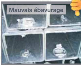
Photos 60 et 61 : Défauts d'ébavurage et de coulure
