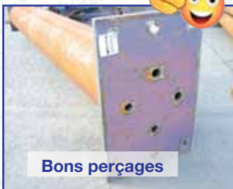
Photos 31 et 32 : Perçages à faire dans l'axe de l'accrochage pour les tubes ronds ou ovales sur platine rectangulaire
