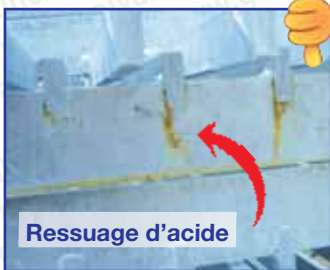
Photos 35 et 36 : Conséquences d'intervalles étroits
