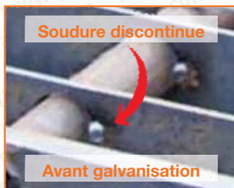
Photos 48 et 49 : Les défauts de soudures discontinues
