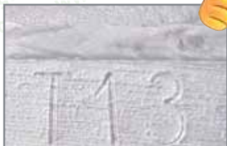
Photos 56 et 57 : La frappe à froid
