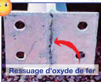
Photos 35 et 36 : Conséquences d'intervalles étroits
