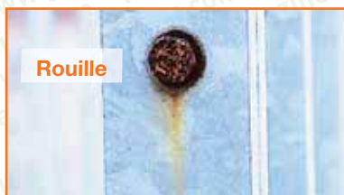
Photo 46 : Boulon électrozingué sur pièce galvanisée, en extérieur
