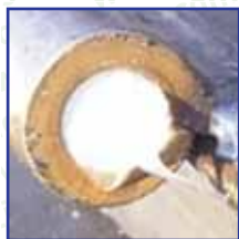
Photos 38, 39 et 40 : Protection par un bouchon de silicone THT ou peinture épargne
