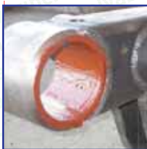
Photos 38, 39 et 40 : Protection par un bouchon de silicone THT ou peinture épargne
